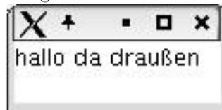
In der Regel wird man nicht die Fenster des Programms nacheinander in der Hauptmethode definieren, sondern die gebrauchten Fenster werden als eigene Objekte definiert. Hierzu leitet man eine spezifische Fensterklasse von der Klasse `JFrame` ab und fügt bereits im Konstruktor die entsprechenden Unterkomponenten hinzu.
