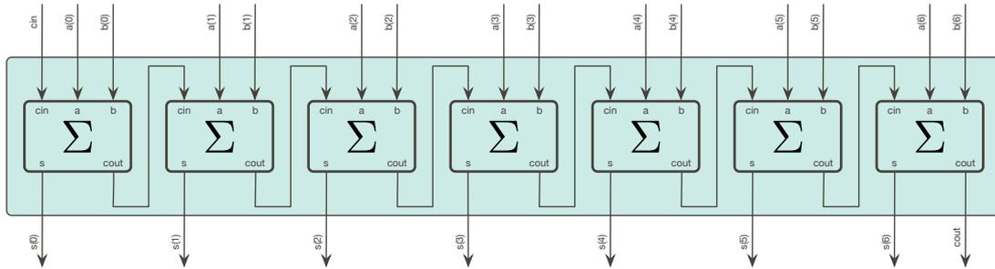
Abbildung 1: Ein Ripple-Carry Adder
