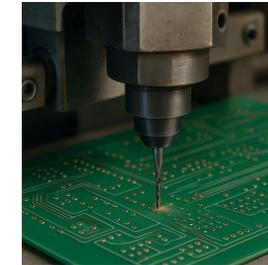
Löcherbohren in Leiterplatten:
