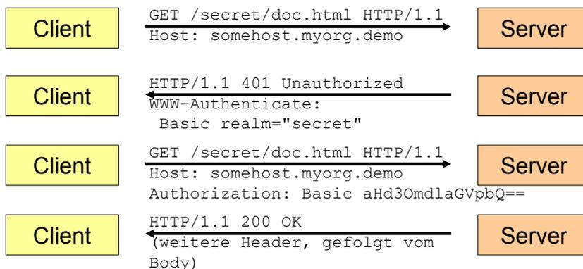
Der Client provoziert mittels GET oder HEAD zunächst einen Serverfehler "401". Der Server fordert zur Autorisierung auf, unter Nennung des betroffenen Serverbereichs.
